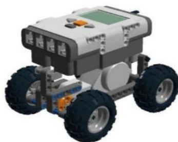
Рис. 3.20. Мотор подключается на порт В.
