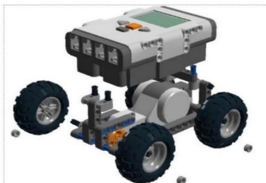
Рис. 3.19. Для надежности колеса закрепляются полушайбами.
